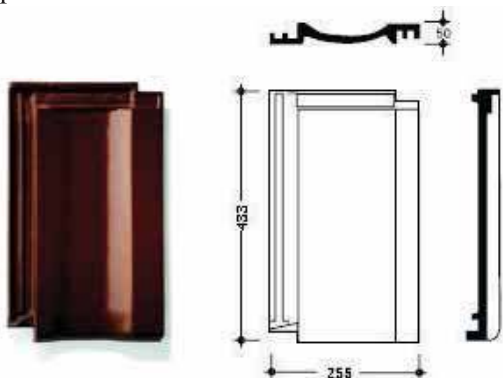
Рис. 14. План черепицы, поперечный и продольный разрезы.
