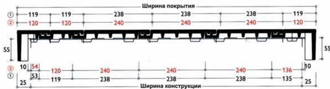
Рис. 28. Продольный разрез кровли с применением на фронте боковой черепицы (левой и правой).
