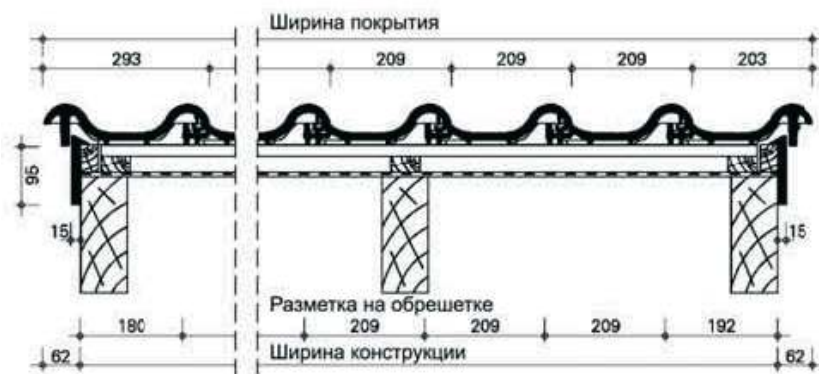
Рис. 10. Продольный разрез кровли с применением на фронте боковой черепицы (левой и правой)
